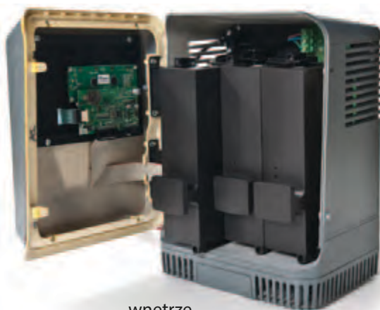
wnętrze 3-modułowego urządzenia
